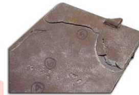
Fig: 3 Cold shut
